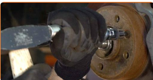
**13** Entfernen Sie die Bremsscheibe.
