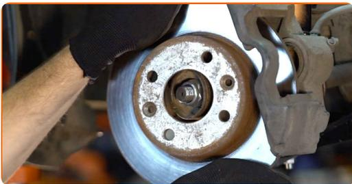
**14** Säubern Sie die Halterung des Bremssattels. Benutzen Sie eine Drahtbürste. Benutzen Sie einen Bremsenreiniger.
