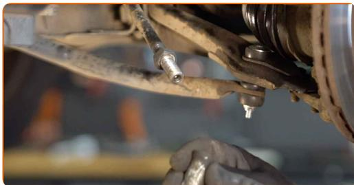
**14** Reinigen Sie die Montagesitze des Spurstangenkopfes. Benutzen Sie eine Drahtbürste. Benutzen Sie WD-40-Spray.
