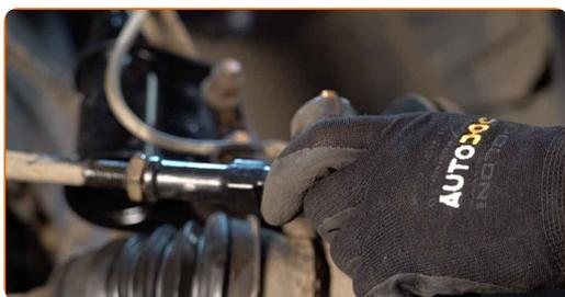
**18** Schrauben Sie die Befestigungsmutter auf, die den Spurstangenkopf mit dem Achsschenkel verbindet. Verwenden Sie Stecknuss Nr. 17.
