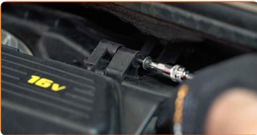
8 Entfernen Sie das Luftfiltergehäuse.
