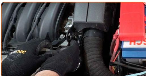
**4** Trennen Sie das Luftansaugrohr vom Luftfilterkasten.
