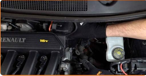
13 Schrauben Sie die Filtergehäuse-Befestigungsbolzen an. Verwenden Sie den Torx T25.
