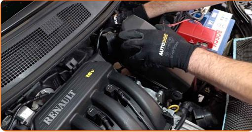
6 Trennen Sie den Kurbelgehäuse-Entlüftungsschlauch vom Ansaugkrümmer.
