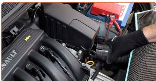
5 Entfernen Sie den Luftfilterkasten.
