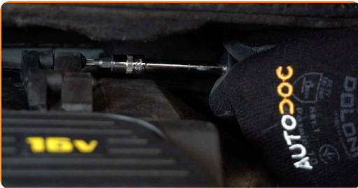
14 Verbinden Sie den Kurbelgehäuse-Entlüftungsschlauch mit dem Ansaugkrümmer.
