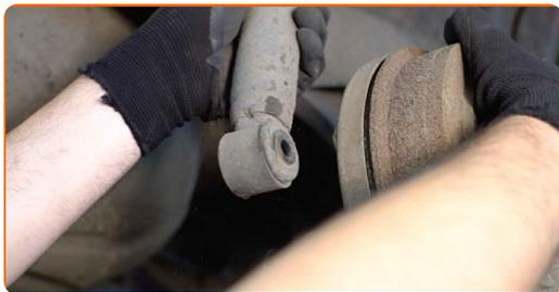
**14** Schrauben Sie die untere Befestigung der Stoßdämpferstrebe ab. Verwenden Sie Stecknuss Nr. 13.
