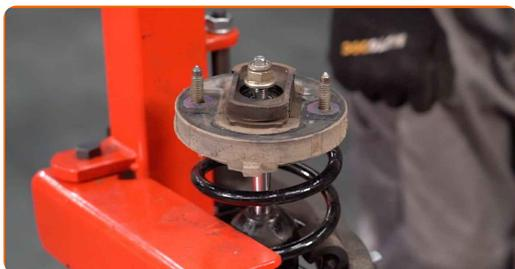
**29** Ziehen Sie die Federbeinkolbenstangenmutter an. Verwenden Sie einen Stoßdämpfer Steckschlüsseinsatz DDN<sup>®</sup>6,3. Verwenden Sie Stecknuss Nr. 17. Verwenden Sie einen Drehmomentschlüssel. Ziehen Sie ihn mit 45 Nm Drehmoment fest.
