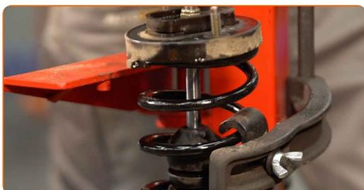
**31** Entfernen Sie das zusammengebaute Federbein.
