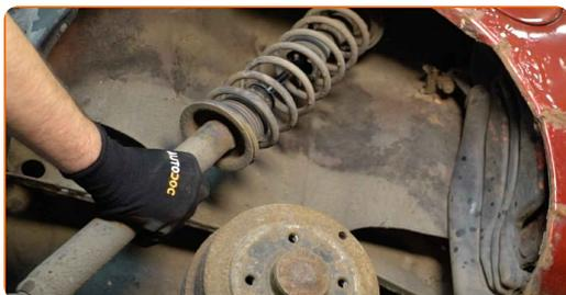
**16** Stellen Sie das Dämpferbein auf das Federspannwerkzeug.
