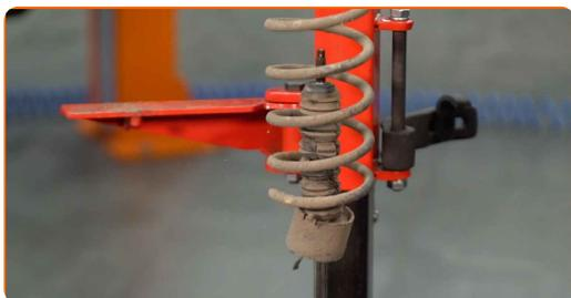
22 Die Staubkappe des Stoßdämpfers und den Anschlagpuffer entfernen.
