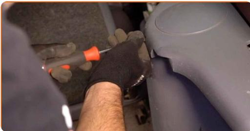
**3** Reinigen Sie die Befestigungselemente der oberen Federbeinhalterung. Benutzen Sie eine Drahtbürste. Benutzen Sie WD-40-Spray.
