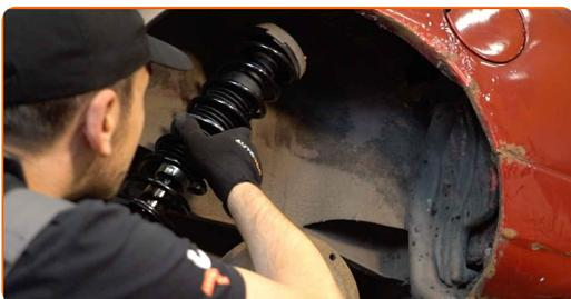
**33** Schrauben Sie die obere Befestigung des Domlagers an. Schrauben Sie diese nicht fest.
