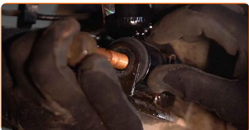
**37** Schrauben Sie das untere Befestigungselement des Federbeins ein. Verwenden Sie Stecknuss Nr. 18.
