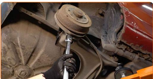
**39** Ziehen Sie die untere Befestigung des Stoßdämpfers an. Verwenden Sie Stecknuss Nr. 18. Verwenden Sie einen Drehmomentschlüssel. Ziehen Sie ihn mit 95 Nm Drehmoment fest.
