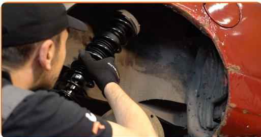
**32** Installieren Sie das Federbein am Radlauf.
