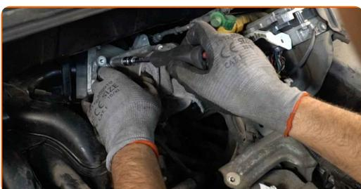
**74** Verbinden Sie den Kurbelgehäuse-Entlüftungsschlauch mit der Motorhaube zur Linken.
