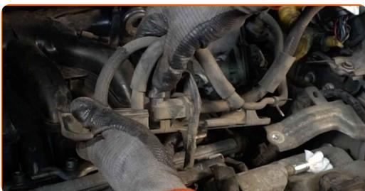
**79** Schrauben Sie die Halterung des Vakuumsystems ein. Verwenden Sie Stecknuss Nr. 12. Verwenden Sie einen Ratschenschlüssel.
