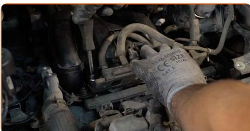
**80** Verbinden Sie den Schlauch des Vakuumsensors.
