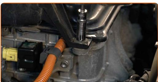
**15** Entfernen Sie den Luftfilterkasten.
