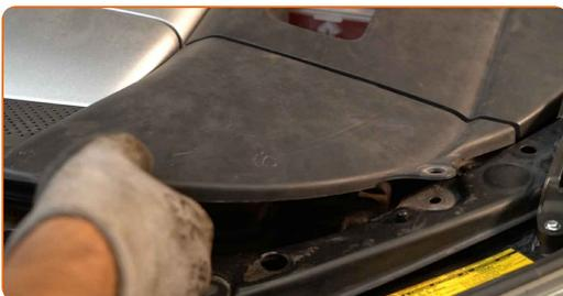
**12** Entfernen Sie die Clips der Motorabdeckung.
