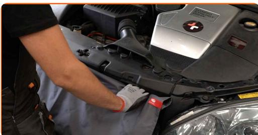
**3** Entfernen Sie die Schlossträgerabdeckung. Verwenden Sie einen Lösehebel, um die Clips zu entfernen.
