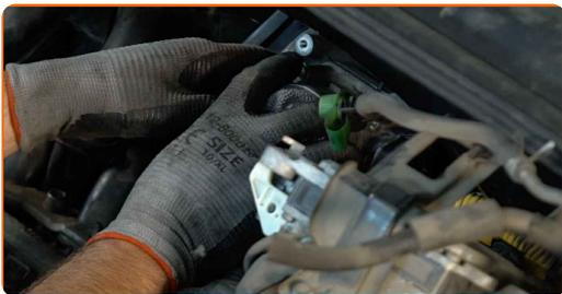
**73** Ziehen Sie die Drosselklappenbefestigungen fest. Verwenden Sie Stecknuss Nr. 12. Verwenden Sie einen Ratschenschlüssel.
