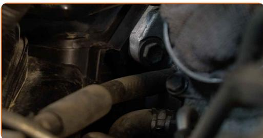
**81** Schrauben Sie die Halterung des Luftfiltergehäuses ein. Verwenden Sie Stecknuss Nr. 12. Verwenden Sie einen Ratschenschlüssel.
