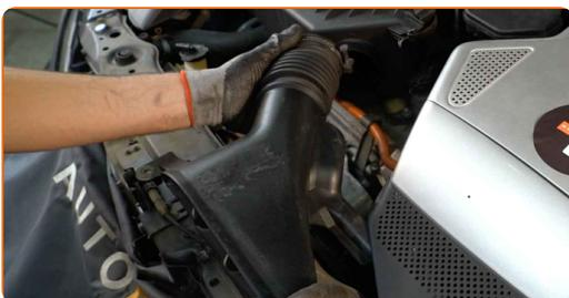
**8** Lösen Sie die Befestigungsclips der Luftfilterabdeckung.
