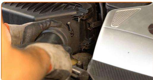
**101** Sichern Sie das Befestigungselement des Luftansaugkanals. Verwenden Sie Stecknuss Nr. 10. Verwenden Sie einen Ratschenschlüssel.
