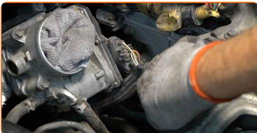
**78** Verbinden Sie den Steckverbinder des Vakuumsensors.
