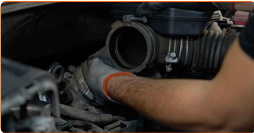
**84** Schrauben Sie die Klemme, die den Luftfilterschlauch mit der Drosselklappe verbindet, ein. Verwenden Sie Stecknuss Nr. 10. Verwenden Sie einen Ratschenschlüssel.
