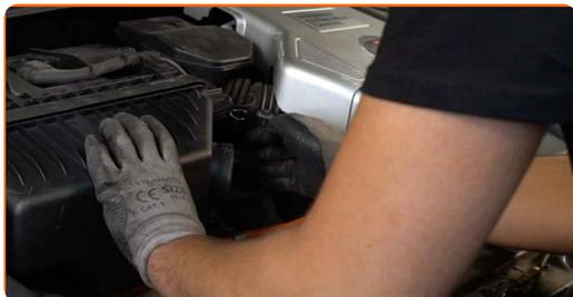
**100** Bringen Sie das Luftkanal-Gehäuse an.
