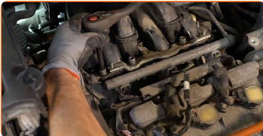
**38** Reinigen Sie die Befestigungen des Ansaugkrümmers.
