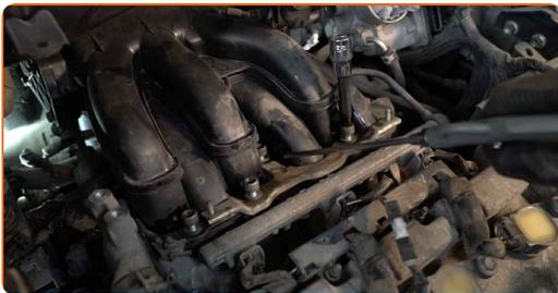
**39** Schrauben Sie die Befestigungselemente, die die Drosselklappe mit dem Ansaugkrümmer verbinden, ab. Verwenden Sie Stecknuss Nr. 12. Verwenden Sie einen Ratschenschlüssel.
