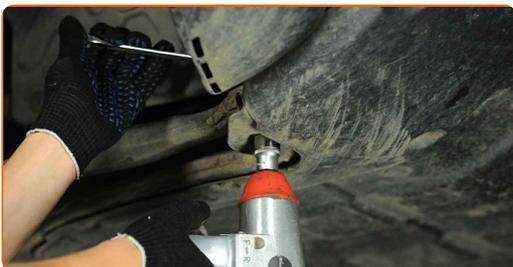
**10** Schrauben Sie das hintere Befestigungselement heraus, das den Querlenker mit dem Hilfsrahmen verbindet. Verwenden Sie Ring-Gabelschlüssel Nr. 19. Verwenden Sie Stecknuss Nr. 19. Verwenden Sie einen Ratschenschlüssel.
