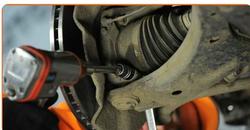
**8** Entfernen Sie die Befestigungsschraube. Verwenden Sie einen Splintentreiber. Benutzen Sie einen Hammer.
