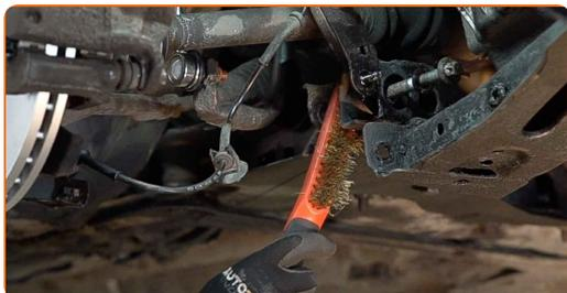
30 Installieren Sie den Arm. Benutzen Sie ein Brecheisen. Verwenden Sie einen Gummi-Hammer.
