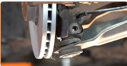
**21** Lösen Sie die Verkabelung des ABS-Sensors vom Querlenker der Aufhängung. Verwenden Sie einen Lösehebel, um die Clips zu entfernen.
