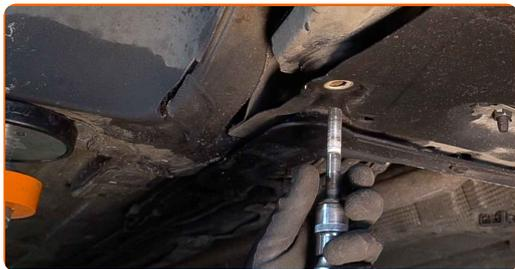
28 Entfernen Sie den Arm. Benutzen Sie ein Brecheisen.
