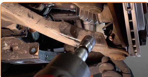
**20** Entfernen Sie die Befestigungsschraube.
