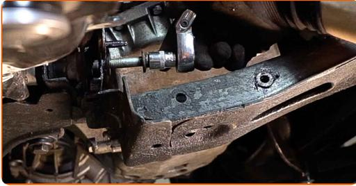
**32** Schrauben Sie die vordere Armbefestigung an. Verwenden Sie Ring-Gabelschlüssel Nr. 18. Verwenden Sie Stecknuss Nr. E16. Verwenden Sie einen Ratschenschlüssel.
