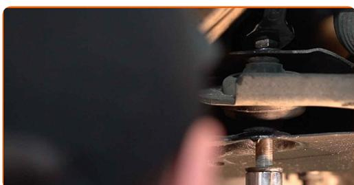
27 Entfernen Sie die Befestigungsschraube.
