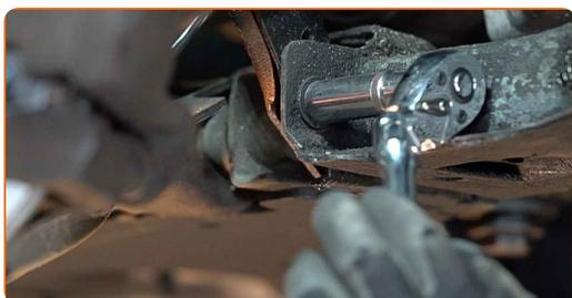
**17** Lösen Sie den Bewehrungsstab des Stoßfängers und ziehen Sie ihn zur Seite. Benutzen Sie ein Brecheisen.
