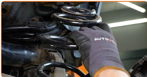
**16** Entfernen Sie die Gummilager der Feder.
