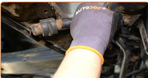
**22** Ziehen Sie die Befestigungen fest, die den Stabilisator mit den Achslenkern verbinden. Verwenden Sie Stecknuss Nr. 13. Verwenden Sie einen Drehmomentschlüssel. Ziehen Sie ihn mit 35 Nm Drehmoment fest.
