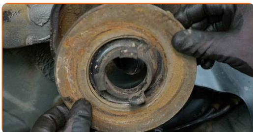
**17** Reinigen Sie die Aufnahmen der Spiralfedern. Benutzen Sie eine Drahtbürste. Benutzen Sie WD-40-Spray.
