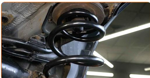
**19** Stützen Sie den hinteren Achsschenkel ab. Benutzen Sie einen hydraulischen Getriebeheber.
