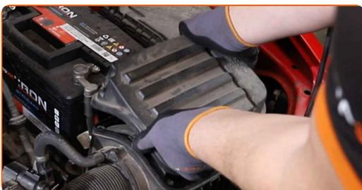
**5** Schrauben Sie die Befestigung des Filterelements ab. Verwenden Sie einen Kreuzschlitzschraubendreher.
