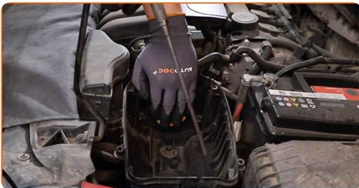
**9** Entfernen Sie das Mikrofaser Tuch vom Luftansaugschlauch.
