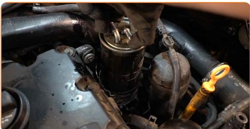
**13** Installieren Sie einen neuen Kraftstofffilter.
