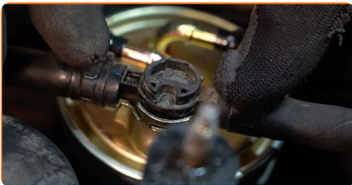
**18** Bringen Sie den Schnellverschluss der Kraftstoffleitung an.
