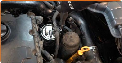
**10** Entfernen Sie den Schnellverschluss der Kraftstoffleitung.
