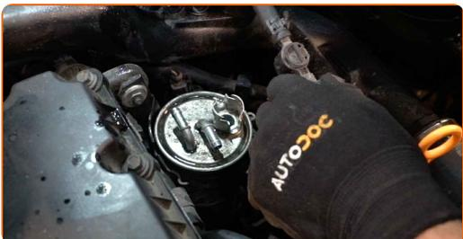
**12** Entfernen Sie den Kraftstofffilter. Legen Sie die alte Filterpatrone in den Behälter.
