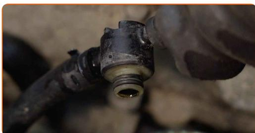
**17** Befestigen Sie die Leitung am Kraftstofffilter.
