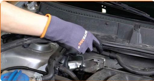
**4** Schrauben Sie die Befestigung der Kunststoffplatte ab. Verwenden Sie einen Kreuzschlitzschraubendreher.
