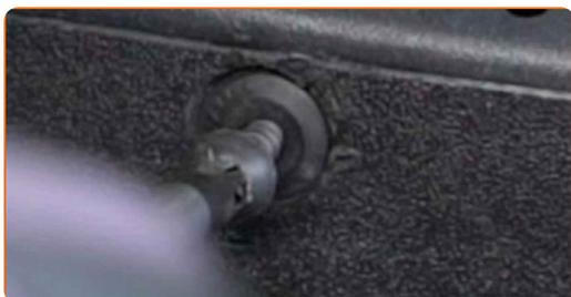
**17** Bauen Sie die Dichtung der Windabweiserabdeckung ein.
