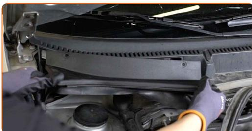
**16** Schrauben Sie die Befestigung der Kunststoffplatte an. Verwenden Sie einen Kreuzschlitzschraubendreher.
