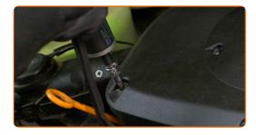
Entfernen Sie die Befestigungsschrauben.
