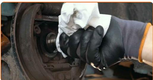
**14** Behandeln Sie die Radnabe im Bereich, in dem sie mit der Bremstrommel in Berührung kommt. Verwenden Sie Mehrzweckfett.
