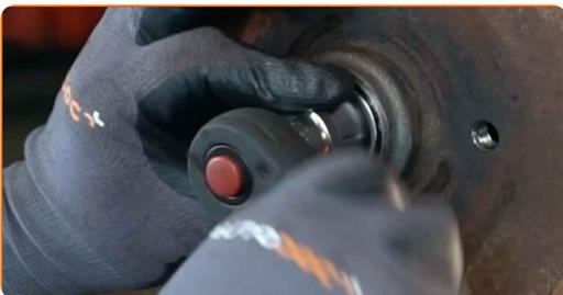
**12** Entfernen Sie die an der Radnabenlagereinheit montierte Bremstrommel.
