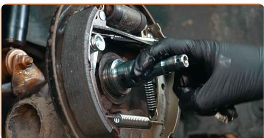
**15** Bringen Sie die neue Bremstrommel an, die an der Radnabenlagereinheit montiert ist.
