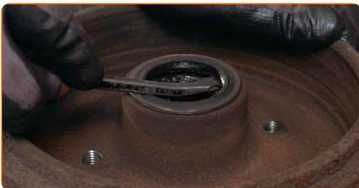
**16** Entfernen Sie die Nabenlagerhalterung. Benutzen Sie ein Brecheisen.
