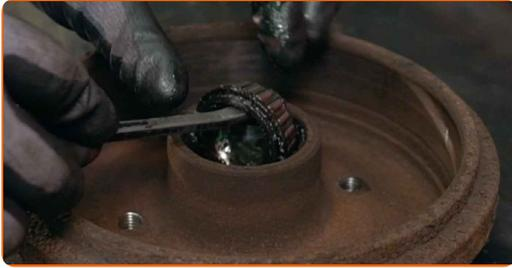
**17** Reinigen Sie den Einbauort für die Nabenlagerung.
