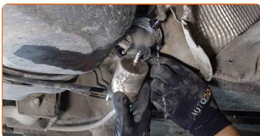
**8** Installieren Sie einen neuen Kraftstofffilter.
