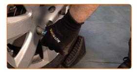
Entfernen Sie den Wagenheber sowie die Unterlegkeile.
