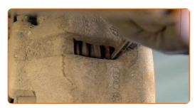
9 Entfernen Sie die Staubschutzkappen der Bremssattel-Führungsstifte. Benutzen Sie ein Brecheisen.
