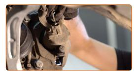
Schrauben Sie die Befestigung des Bremssattels ab. Verwenden Sie Inbusschlüssel Nr. H7. Verwenden Sie einen Ratschenschlüssel.
