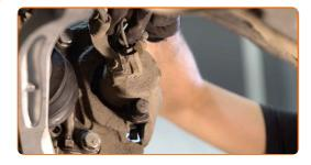
Verbinden Sie den Bremsbelag-Verschleiß-Sensor.
