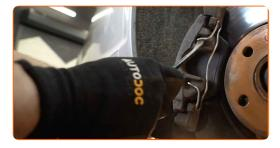
12 Entfernen Sie den Bremssattel.
