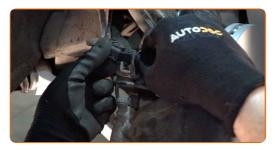
Bauen Sie die Bremssattel-Haltefeder ein. Benutzen Sie ein Brecheisen.
