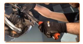
Installieren Sie die Staubschutzkappen der Bremssattel-Führungsstifte.
