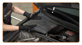
4 Entfernen Sie den Gehäusedeckel des Innenraumfilters.
