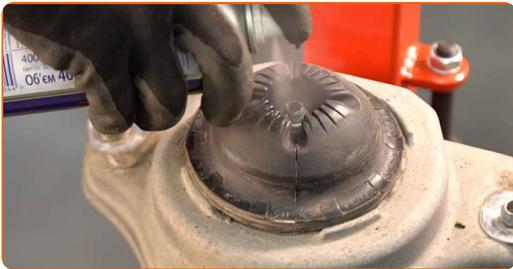
**24** Entfernen Sie die Stangenmutter des Federkolben. Verwenden Sie Stecknuss Nr. 19. Verwenden Sie einen Ratschenschlüssel.
