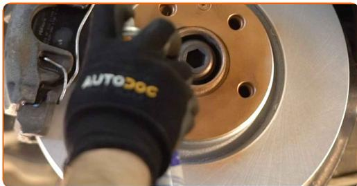
**55** Die Bremsscheibenoberfläche reinigen. Benutzen Sie einen Bremsenreiniger.
