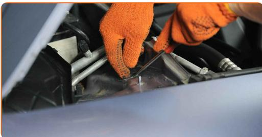
**19** Schrauben Sie das obere Befestigungselement des Federbeins ab. Verwenden Sie Stecknuss Nr. 16. Verwenden Sie einen Ratschenschlüssel.
