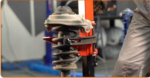
**23** Behandeln Sie die Federbeinstange. Benutzen Sie eine Drahtbürste. Benutzen Sie WD-40-Spray.
