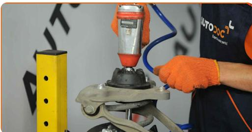
**25** Entfernen Sie die obere Stoßdämpferhalterung, die mit den Querlenkern zusammengebaut ist.
