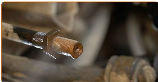
**14** Schrauben Sie einen neuen Spurstangenkopf an. Verwenden Sie einen Messschieber.
