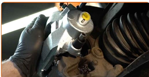
**20** Installieren Sie die Staubschutzkappen der Bremssattel-Führungsstifte.
