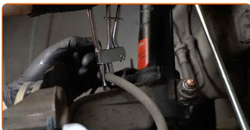
**26** Verbinden Sie den Schlauch des Bremsentlüftungs-Kits mit der Bremsentlüftungsschraube.
