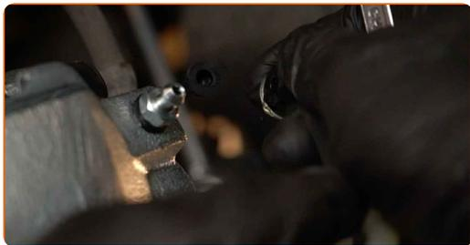
**30** Ziehen Sie die Entlüftungsschraube des Bremssattels an. Verwenden Sie Stecknuss Nr. 11. Verwenden Sie einen Drehmomentschlüssel. Ziehen Sie ihn mit 9 Nm Drehmoment fest.
