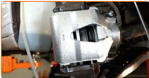
**27** Entlüften Sie das Bremssattelsystem. Ohne das Starten des Motors drücken Sie das Bremspedal mehrmals, bis Sie signifikanten Widerstand spüren.
