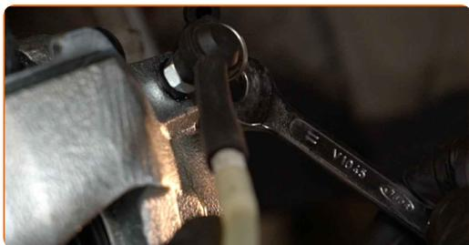
**29** Trennen Sie den Schlauch des Bremsentlüftungs-Kits.
