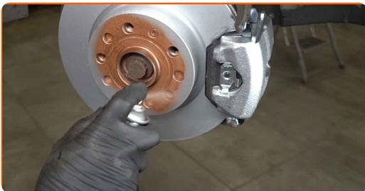
**32** Die Bremsscheibenoberfläche reinigen. Benutzen Sie einen Bremsenreiniger.
