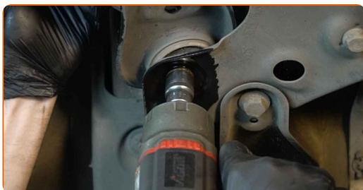
**9** Entfernen Sie die Befestigungsschrauben. Verwenden Sie Stecknuss Nr. 18.
