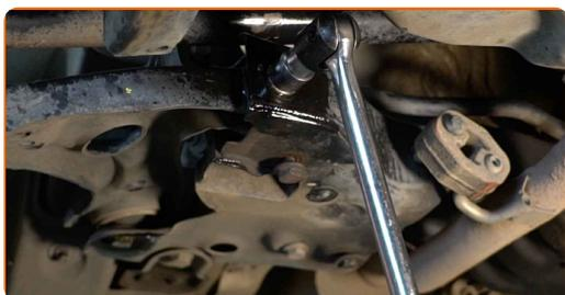
**8** Schrauben Sie das hintere Befestigungselement heraus, das den Querlenker mit dem Hilfsrahmen verbindet. Verwenden Sie Ring-Gabelschlüssel Nr. 18. Verwenden Sie Stecknuss Nr. 18. Verwenden Sie ein Windeisen.
