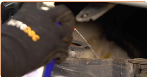
**19** Lösen Sie die obere Befestigung des Domlagers. Verwenden Sie Stecknuss Nr. 20.6. Verwenden Sie einen Ratschenschlüssel.
