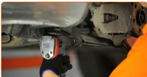
**8** Entfernen Sie die Befestigungsschraube.
