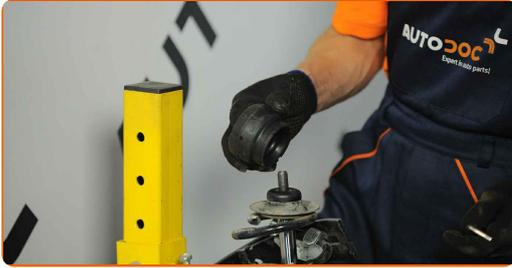
**32** Ziehen Sie die Federbeinkolbenstangenmutter an. Verwenden Sie Stecknuss Nr. 20.6. Verwenden Sie Inbusschlüssel Nr. H6. Verwenden Sie einen Drehmomentschlüssel. Ziehen Sie ihn mit 60 Nm Drehmoment fest.
