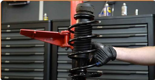
**36** Installieren Sie das Federbein am Radlauf.
