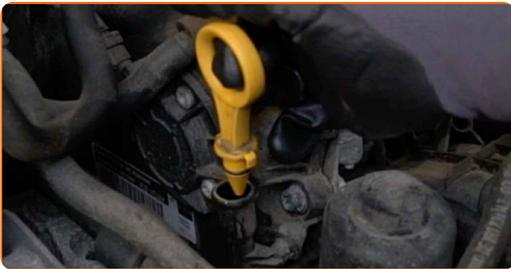
**7** Schrauben Sie den Filtergehäusedeckel zusammen mit dem alten Filterelement ab. Verwenden Sie Stecknuss Nr. 32. Verwenden Sie einen Ratschenschlüssel.
