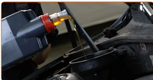
**Austausch: Motoröl und Ölfilter – SEAT LEON ST Kasten/Kombi (5F8).
