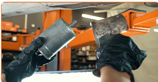
**12** Befestigen Sie die Leitung am Kraftstofffilter.
