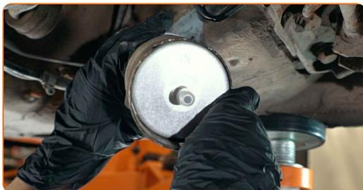
**14** Befestigen Sie die Leitung am Kraftstofffilter.
