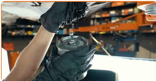
**11** Entfernen Sie die Halterung des Kraftstofffilters.
