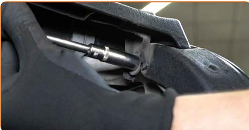
**4** Entfernen Sie die Seitenabdeckung aus Kunststoff.
