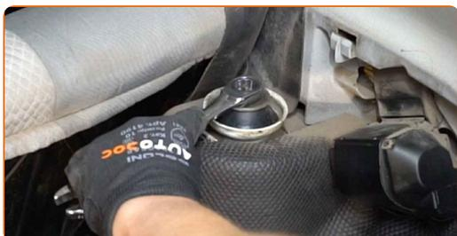
**53** Behandeln Sie die Befestigungselemente des Federbeinstützlagers. Benutzen Sie ein Kupferschmiermittel.
