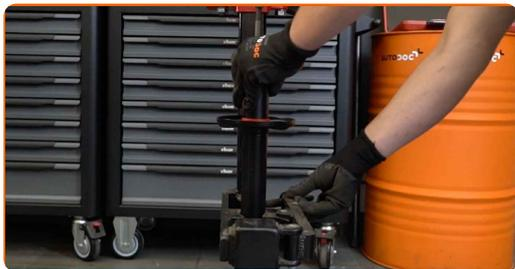
**29** Installieren Sie die Feder am Stoßdämpfer.
