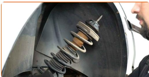
**19** Stellen Sie das Dämpferbein auf das Federspannwerkzeug.
