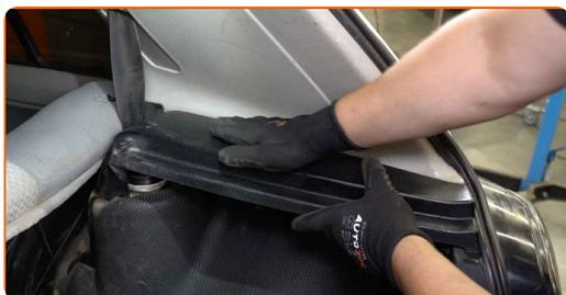
**55** Schrauben Sie die Befestigungen der Kunststoffplatten der Seitenverkleidung ein. Verwenden Sie Stecknuss Nr. 10. Verwenden Sie einen Ratschenschlüssel.
