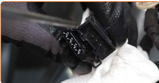
**47** Behandeln Sie den Stecker des Fensterheberschaltermoduls mit einem Kontaktspray. Verwenden Sie dielektrisches Fett.
