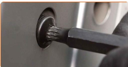
**52** Schrauben Sie die Befestigungen des Türschlosses fest. Benutzen Sie den XZN #8. Verwenden Sie einen Drehmomentschlüssel. Ziehen Sie ihn mit 20 Nm Drehmoment fest.
