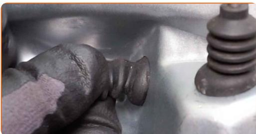
**43** Behandeln Sie den Stecker des elektrischen Fensterhebermoduls. Verwenden Sie dielektrisches Fett.
