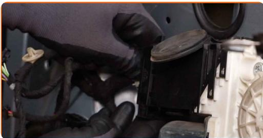
**45** Behandeln Sie die Stecker der Lautsprecher mit einem Kontaktspray. Verwenden Sie dielektrisches Fett.
