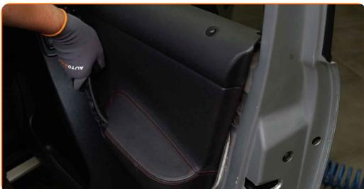
**65** Schrauben Sie die Befestigungen der Türinnenverkleidung ein. Verwenden Sie einen Kreuzschlitzschraubendreher.
