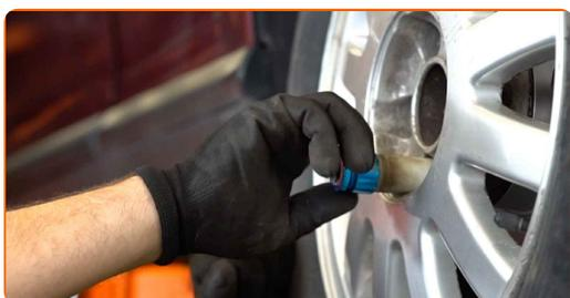
**33** Senken Sie das Auto und ziehen Sie die Radschrauben über Kreuz an. Verwenden Sie einen Drehmomentschlüssel. Ziehen Sie ihn mit 120 Nm Drehmoment fest.
