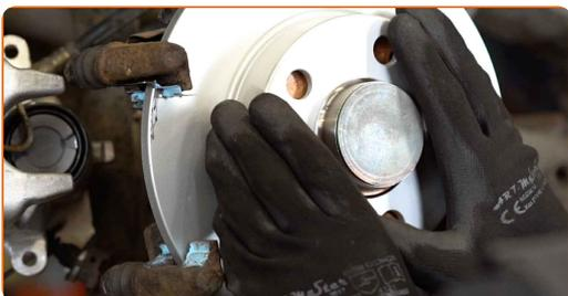
**25** Ziehen Sie die Befestigung der Bremsscheibe fest. Verwenden Sie den Torx T30. Verwenden Sie einen Drehmomentschlüssel. Ziehen Sie ihn mit 4 Nm Drehmoment fest.
