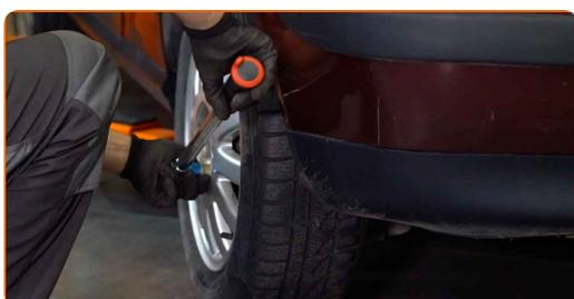
**34** Entfernen Sie den Wagenheber sowie die Unterlegkeile.
