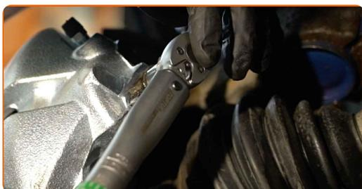
**23** Entfernen Sie die Klammer des Bremsschlauchs.
