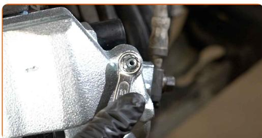
**25** Verbinden Sie den Schlauch des Bremsentlüftungs-Kits mit der Bremsentlüftungsschraube.
