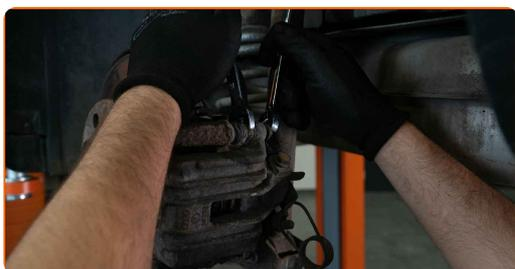
**11** Entfernen Sie den Bremssattel.
