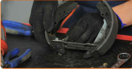
**16** Entfernen Sie beide Beläge von dem Träger.
