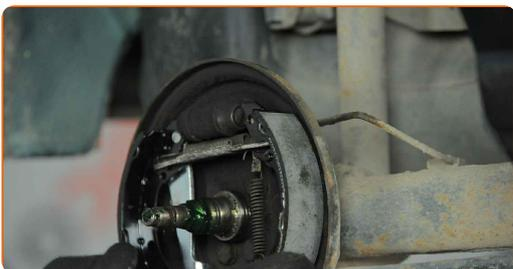
**23** Bringen Sie die Halteclips der Bremsbeläge an. Verwenden Sie Zangen.
