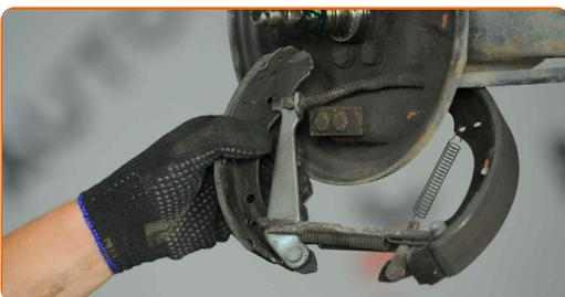
**15** Entfernen Sie die Rückholfeder der Bremsbeläge.
