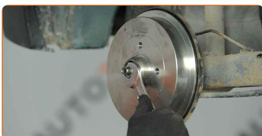
**27** Installieren Sie den Splint der Nabe an der Lagerbefestigungsmutter. Benutzen Sie einen Hammer. Verwenden Sie eine Kneifzange.
