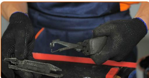
**18** Montieren Sie die oberen Haltefedern und die Verstellmechanismen auf die neuen Bremsbacken. Verwenden Sie Zangen.
