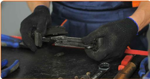
**17** Führen Sie eine weitere Demontage der oberen Haltefeder und des Verstellmechanismus durch. Verwenden Sie Zangen.
