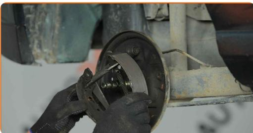
**Austausch: Bremsbacken – SKODA FABIA Stufenheck (6Y3). Tipp von AUTODOC-Experten:**
