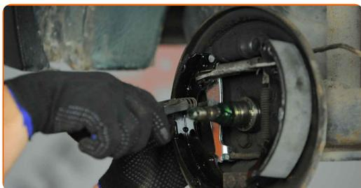
**24** Bringen Sie die Rückholdfeder der Bremsbeläge an. Verwenden Sie Zangen.
