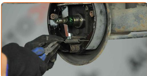
**25** Installieren Sie eine Bremstrommel.
