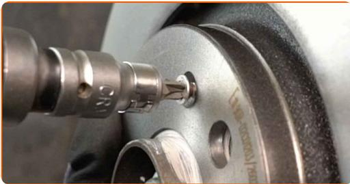
**21** Schrauben Sie die Befestigungen der Bremsscheibe fest. Verwenden Sie einen Kreuzschlitzschraubendreher. Verwenden Sie einen Drehmomentschlüssel. Ziehen Sie ihn mit 4 Nm Drehmoment fest.
