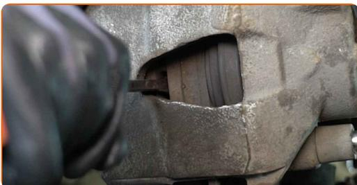
**11** Entfernen Sie den Bremssattel.
