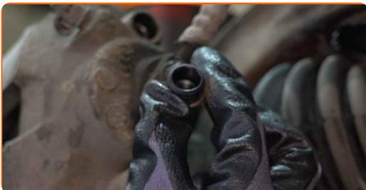
**9** Schrauben Sie die Befestigungen des Bremssattels ab. Verwenden Sie Inbusschlüssel Nr. H7. Verwenden Sie einen Ratschenschlüssel.
