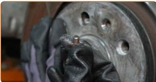
**15** Entfernen Sie die Bremsscheibe.
