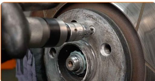
**14** Entfernen Sie die Befestigungsschraube.
