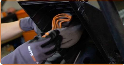
**11** Setzen Sie die Luftfilterabdeckung wieder auf und befestigen Sie sie.
