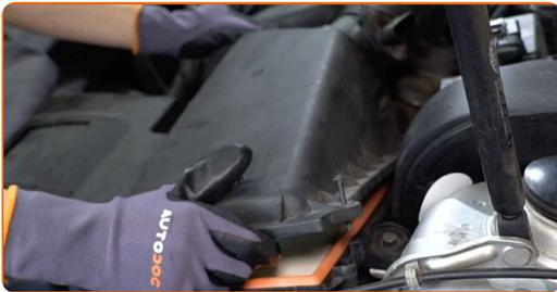
**12** Drehen Sie die Befestigungsschrauben der Luftfilter-Abdeckung ein. Verwenden Sie einen Kreuzschlitzschraubendreher.
