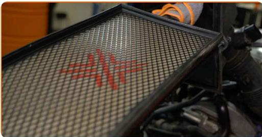
**8** Reinigen Sie die Abdeckung und das Gehäuse des Luftfilters.
