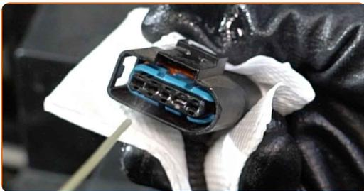
**14** Bringen Sie den Steckverbinder des Luftmassenmessers an.
