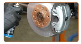
Die Bremsscheibenoberfläche reinigen. Benutzen Sie einen Bremsenreiniger.
