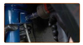
Drehen Sie die Befestigungen heraus, die die Druckstange mit dem Stabilisator verbinden. Verwenden Sie Ring-Gabelschlüssel Nr. 18. Benutzen Sie den XZN #6. Verwenden Sie einen Ratschenschlüssel.
