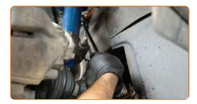
Ziehen Sie das Befestigungselement an, das die Druckstange mit dem Federbein verbindet. Verwenden Sie Stecknuss Nr. 18. Verwenden Sie einen Drehmomentschlüssel. Ziehen Sie ihn mit 60 Nm Drehmoment fest.
