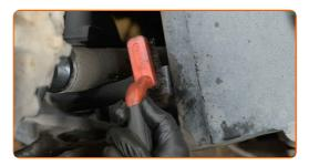
Bringen Sie eine neue Stange an, ziehen Sie die Schrauben fest. Verwenden Sie Ring-Gabelschlüssel Nr. 18. Verwenden Sie Stecknuss Nr. 18. Verwenden Sie Inbusschlüssel Nr. H5. Verwenden Sie einen Ratschenschlüssel.
