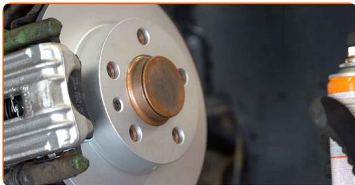
**34** Die Bremsscheibenoberfläche reinigen. Benutzen Sie einen Bremsenreiniger.
