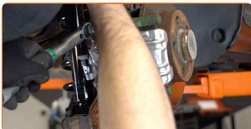
**18** Drehen Sie die Bremsleitungsschraube auf. Verwenden Sie Inbusschlüssel Nr. H6. Verwenden Sie einen Ratschenschlüssel.
