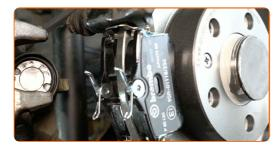
Montieren Sie den Bremssattel.
