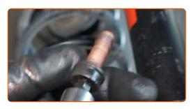
Entfernen Sie den Bremssattelhalter.
