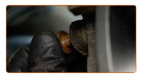
Ziehen Sie die Befestigungen des Bremssattelhalters fest. Verwenden Sie Inbusschlüssel Nr. H8. Verwenden Sie einen Drehmomentschlüssel. Ziehen Sie ihn mit 65 Nm Drehmoment fest.
