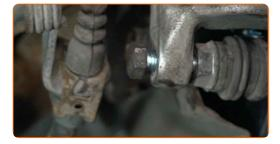
Ziehen Sie die Bremssattelbefestigungen fest. Verwenden Sie Stecknuss Nr. 13. Verwenden Sie einen Drehmomentschlüssel. Ziehen Sie ihn mit 35 Nm Drehmoment fest.
