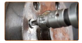
Entfernen Sie die Befestigungsschraube.
