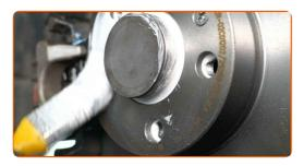
Die Bremsscheibenoberfläche reinigen. Benutzen Sie einen Bremsenreiniger.
