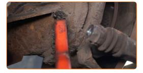
Schrauben Sie die Befestigungen des Bremssattelhalters ab. Verwenden Sie Inbusschlüssel Nr. H8. Verwenden Sie einen Ratschenschlüssel.
