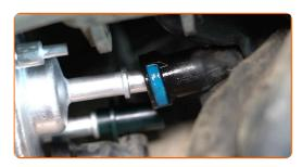
Schrauben Sie den Befestigungssitz des Kraftstofffilters ein. Verwenden Sie einen Kreuzschlitzschraubendreher.
