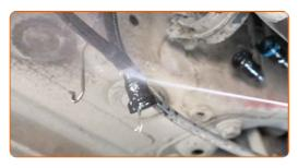
Installieren Sie einen neuen Kraftstofffilter.
