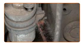
Lockern Sie die Befestigungen des Kraftstofffilters. Verwenden Sie einen Kreuzschlitzschraubendreher.
