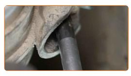
Den Flüssigkeitsbehälter unter dem Kraftstofffilter entfernen.
