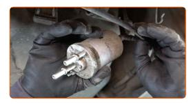
Reinigen Sie die Kraftstoffleitungen. Verwenden Sie Allzweckreinigungsspray.
