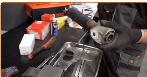
**17** Bringen Sie das neue Stützlager, die Manschette und den Anschlagpuffer am Stoßdämpfer an.
