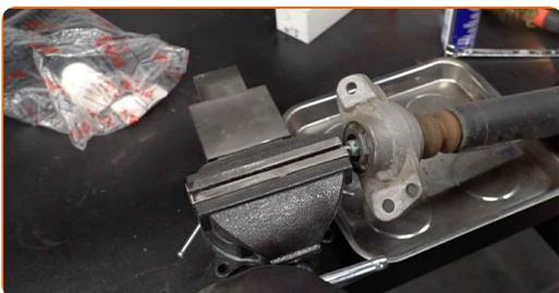
**15** Entfernen Sie die Befestigung der Stoßdämpferkolbenstange. Verwenden Sie Ring-Gabelschlüssel Nr. 14.
