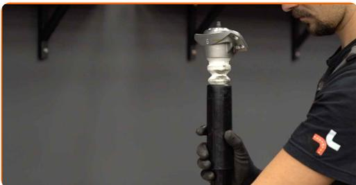
**18** Fixieren Sie die Stoßdämpferbefestigung. Verwenden Sie Ring-Gabelschlüssel Nr. 14. Verwenden Sie Stecknuss Nr. 14. Verwenden Sie einen Drehmomentschlüssel. Ziehen Sie ihn mit 25 Nm Drehmoment fest.
