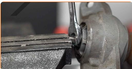
**16** Entfernen Sie die Stoßdämpferhalterung, die Manschette und den Stoßstopp.
