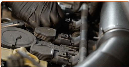
**5** Entnehmen Sie die Zündspule aus der Vertiefung für die Zündkerze.
