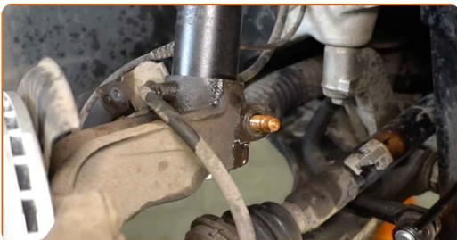
**52** Entfernen Sie den Träger unter dem Achsschenkel.
