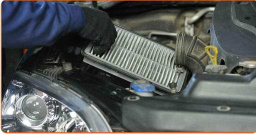
**10** Reinigen Sie die Abdeckung und das Gehäuse des Luftfilters.
