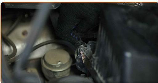
**14** Verbinden Sie das Luftansaugrohr mit dem Luftfilter-Gehäuse.
