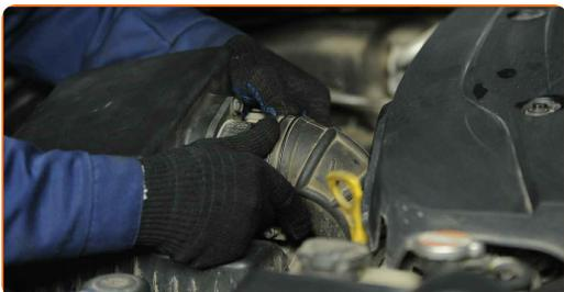
**15** Ziehen Sie die Klemme am Luftansaugschlauch fest. Verwenden Sie einen Kreuzschlitzschraubendreher.
