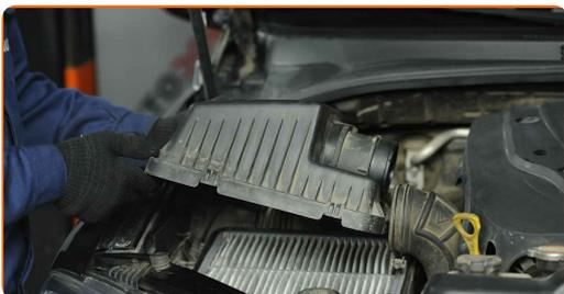
**9** Entfernen Sie das Filterelement aus dem Filtergehäuse.
