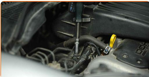
**5** Trennen Sie das Luftansaugrohr vom Luftfilter-Gehäuse.
