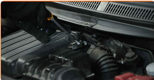
**4** Lösen Sie den Verschluss des Luftfiltergehäuses. Verwenden Sie Stecknuss Nr. 10. Verwenden Sie einen Ratschenschlüssel.
