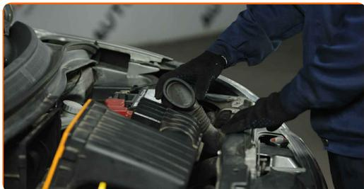
**6** Entfernen Sie das Luftfiltergehäuse.
