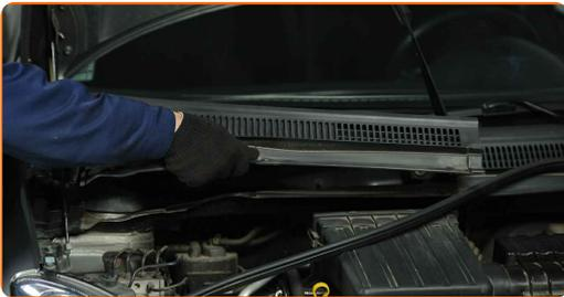
**48** Bringen Sie die Befestigungselemente der Windlaufabdeckung an.
