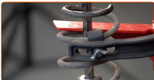
**28** Behandeln Sie die Federbeinstange. Benutzen Sie eine Drahtbürste. Benutzen Sie WD-40-Spray.
