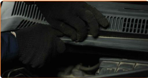
**49** Entfernen Sie die Kotflügel-Abdeckung.
