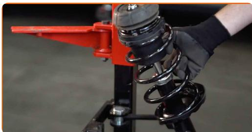
**43** Installieren Sie das Federbein am Radlauf.
