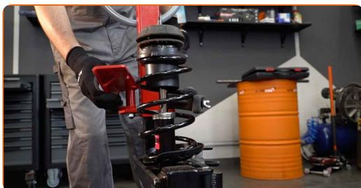
**42** Entfernen Sie das zusammengebaute Federbein.
