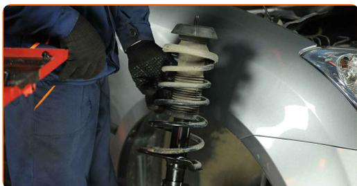
**44** Schrauben Sie die obere Befestigung des Domlagers an.
