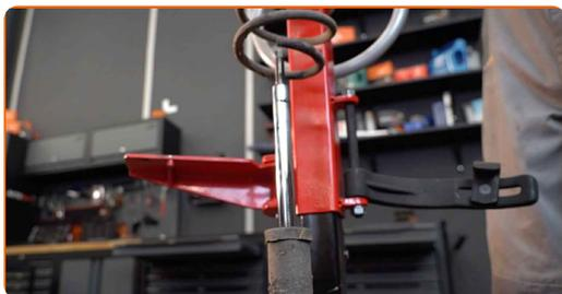
**33** Die Staubkappe des Stoßdämpfers und den Anschlagpuffer entfernen.
