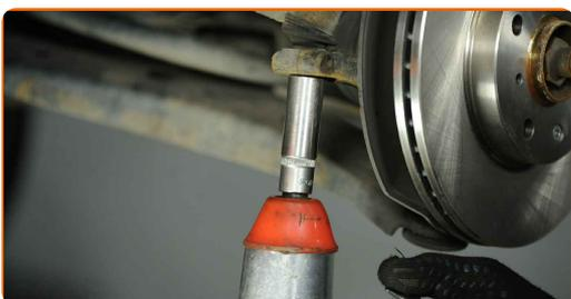
**11** Ziehen Sie den Spurstangenkopf vom Achsschenkel. Verwenden Sie einen Kugelgelenkabzieher.
