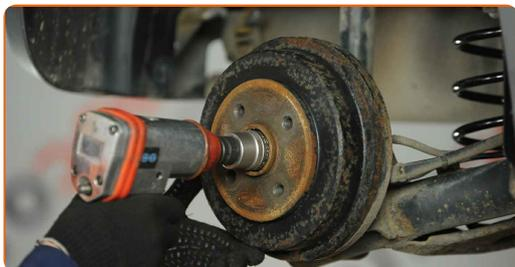
**9** Entfernen Sie die an der Radnabenlagereinheit montierte Bremstrommel.
