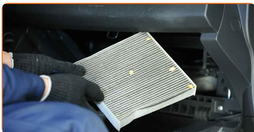
Austausch: Innenraumfilter – SUZUKI SX4 Stufenheck (GY). Tipp von AUTODOC:
