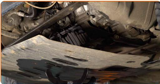
7 Reinigen Sie den Bereich um die Ablassöffnung der Ölwanne. Verwenden Sie Allzweckreinigungsspray.
