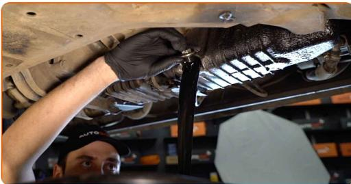
Austausch: Motoröl und Ölfilter – VW Transporter T4. Tipp von AUTODOC-Experten:
