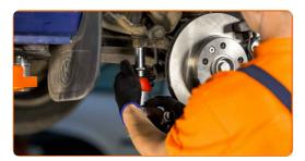
Ziehen Sie den Spurstangenkopf vom Achsschenkel. Verwenden Sie einen Kugelgelenkabzieher. Benutzen Sie einen Hammer.
