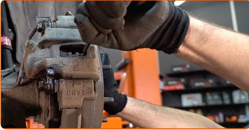
**9** Schrauben Sie die Befestigung des Bremssattels ab. Verwenden Sie Stecknuss Nr. 17. Verwenden Sie ein Windeisen.
