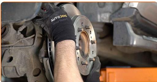
**19** Säubern Sie die Halterung des Bremssattels. Benutzen Sie eine Drahtbürste. Benutzen Sie einen Bremsenreiniger.
