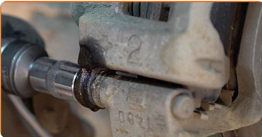
**10** Entfernen Sie den Bremssattel.
