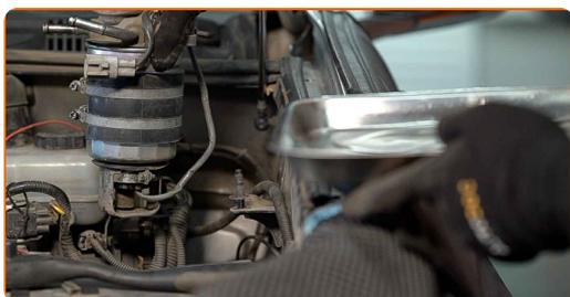
**8** Schrauben Sie die Halterung des WIF-Sensors heraus. Verwenden Sie Stecknuss Nr. 8.
