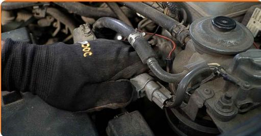
**4** Lockern Sie die Befestigungsklemme der Kraftstofffilterleitung. Verwenden Sie eine Rundzange.
