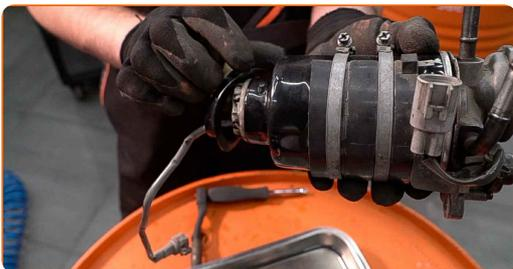
**26** Schrauben Sie die Halterung des WIF-Sensors ein. Verwenden Sie Stecknuss Nr. 8. Verwenden Sie einen Ratschenschlüssel.
