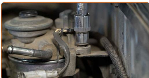
**7** Entfernen Sie den Kraftstofffilter. Legen Sie die alte Filterpatrone in den Behälter.
