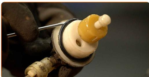
**22** Reinigen Sie den WIF-Sensor. Verwenden Sie Allzweckreinigungsspray.
