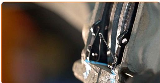
**18** Bringen Sie die Halteclips der Bremsbeläge an.
